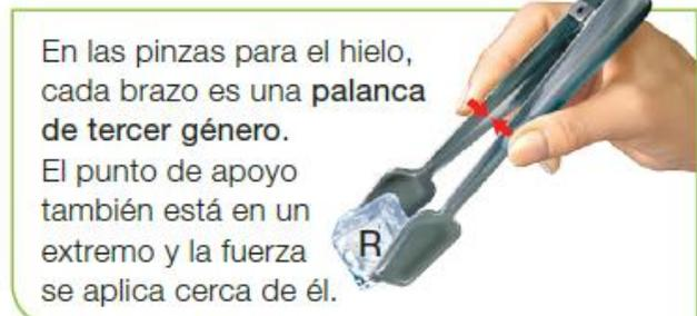
Las máquinas simples constan de una o de pocas piezas. Son la polea, el plano inclinado y la palanca.
