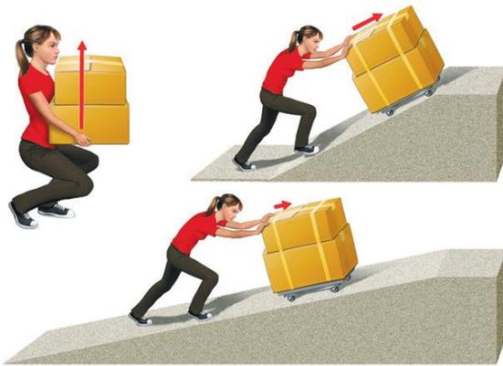
Un plano inclinado es una superficie plana que sirve para elevar cargas a una cierta altura. Nos permite elevar la carga empujándola, en vez de levantándola, que necesita más fuerza.
