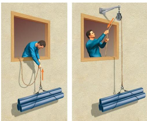
Una polea es una máquina que está formada por una rueda sujeta a algún soporte. Esta rueda tiene un surco por el que pasa y una cuerda o una cadena. Sirve para elevar objetos pesados. Para ello, hay que ejercer una fuerza sobre la cuerda que contrarreste el peso del objeto.
