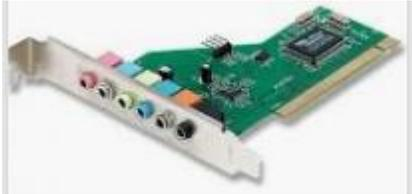
**Tarjeta de sonido:** la tarjeta de sonido reproduce música con calidad, algunas de ellas pueden convertir su computador en un moderno estudio de grabación. En este caso incluye conversiones A/D y D/A para la grabación y reproducción de señales de audios exteriores, chips con muestras de instrumentos digitalizados, un interfaz de sonido MIDI.
